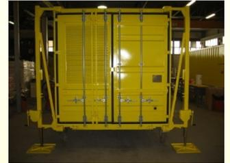
Contenedor con superficie útil operacional de 24 m<sup>2</sup> y volumen útil de 54 m<sup>3</sup>, que sirve para instalación de puesto de mando autónomo y alojamiento del personal operativo.
